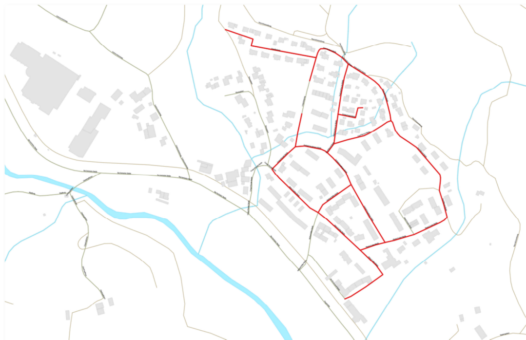
Abbildung 29: Detailprojekt Bischofswiesen: Möglicher Trassenverlauf der Nahwärmeverbundlösung
